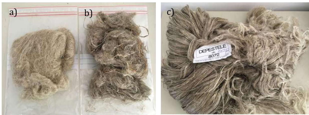
Figure 1 : Images des matières fournies par DEPESTELE : a) Des étoupes de haute qualité b) Des étoupes avec des anas c) Des fibres de haute qualité 8072es
