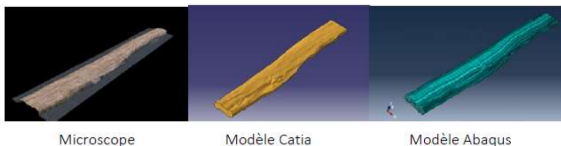
Figure 9 : Obtention d'un modèle numérique de roving utilisable pour la simulation numérique à partir d'une image 3D provenant du microscope numérique
