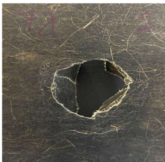
Fig 6. Apparence des échantillons NNW après l'essai d'impact
