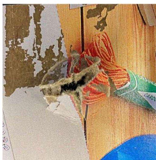
Fig 5. Apparence des échantillons de CNW après l'essai d'impact
