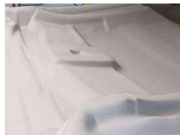
Positionnement de la garniture de pavillon sur le support de découpe au jet d'eau
