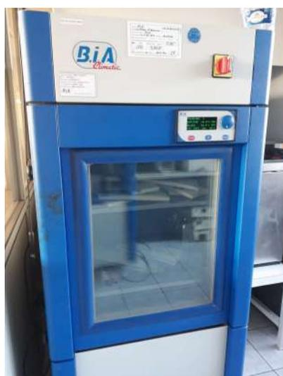
Chambre de chauffe pour l'analyse de l'humidité
