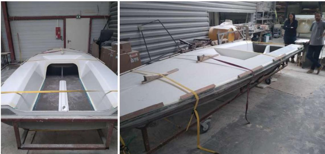
*Assemblage coque / pont*
