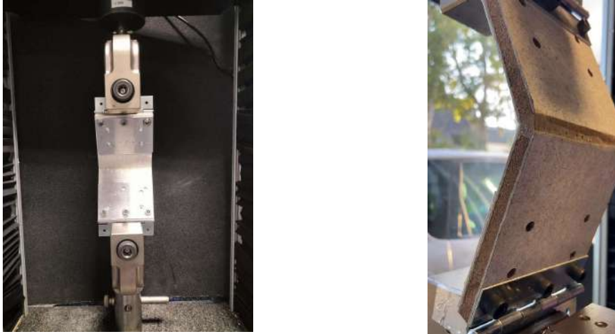
Figure 4 : montage des éprouvettes dans la machine de traction
