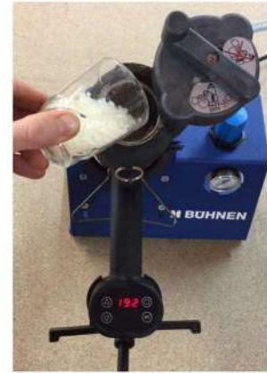
Figure 3 : remplissage du pistolet à colle
