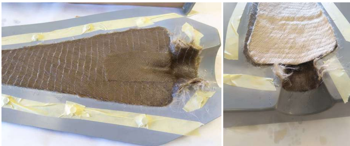
Figure 3. Images de fabrication des pales
