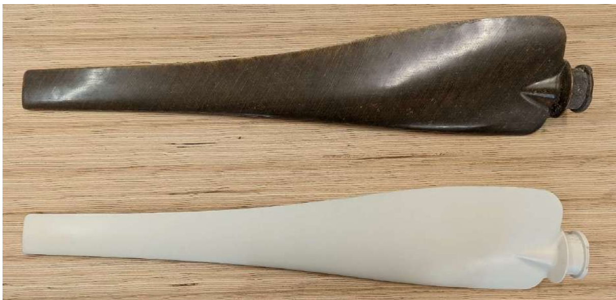
Figure 5. Lame prototype en composite lin-époxy, placée par rapport à la lame conventionnelle en verre/nylon.
