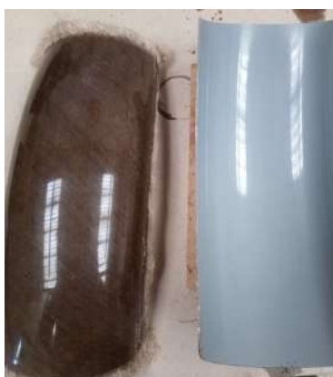
Figure 2. Essai préliminaire réussi de pose à la main sur la surface de l'outil de moulage.
