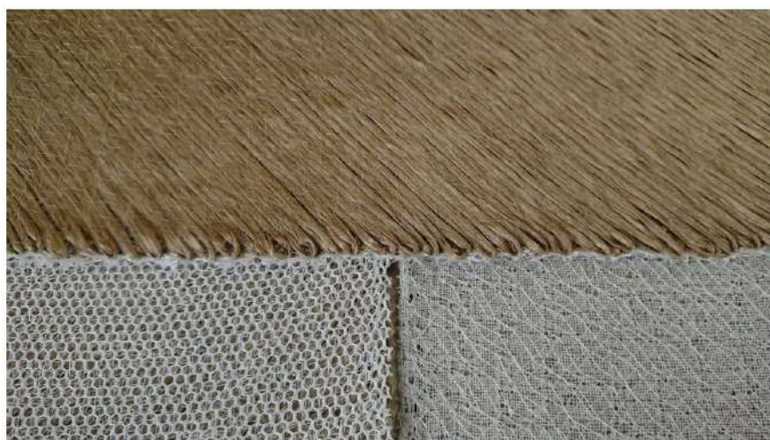
Figure 4 : supports pour NCF \pm 45^\circ . A gauche : tissu de type LENO, à droite : voile non-tissé PP
