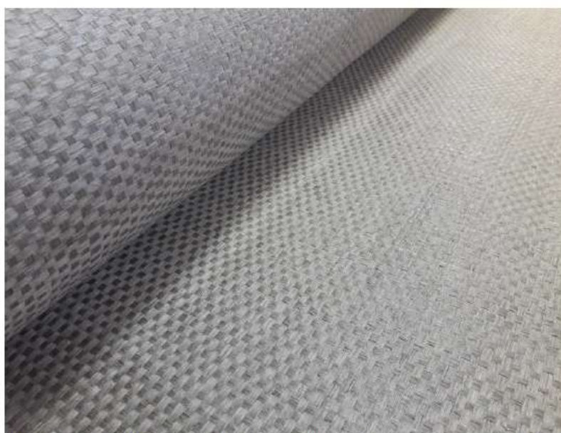
Figure 6 : renfort 100% lin à 170 g/m 2 , obtenu par tissage à plat (métier PANTER)
