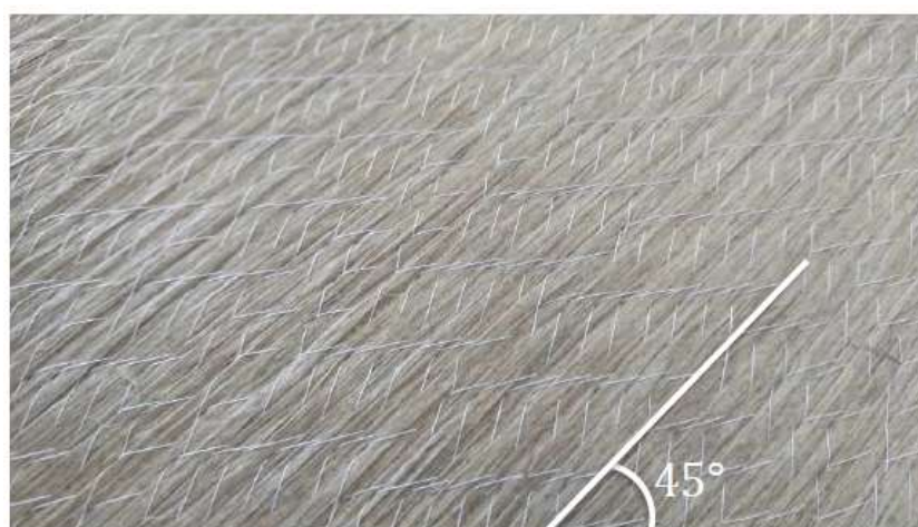
Figure 3 : NCF \pm 45^\circ obtenu par TFP
