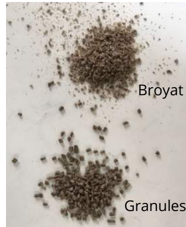
Figure 13 : différence entre le broyat et les granules extrudés
