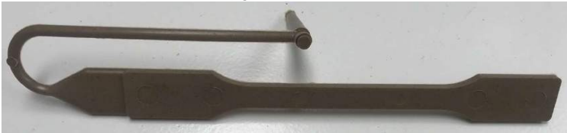
Figure 15 : éprouvette injectée à partir de granules (PLA/PBS) / Lin 14%
