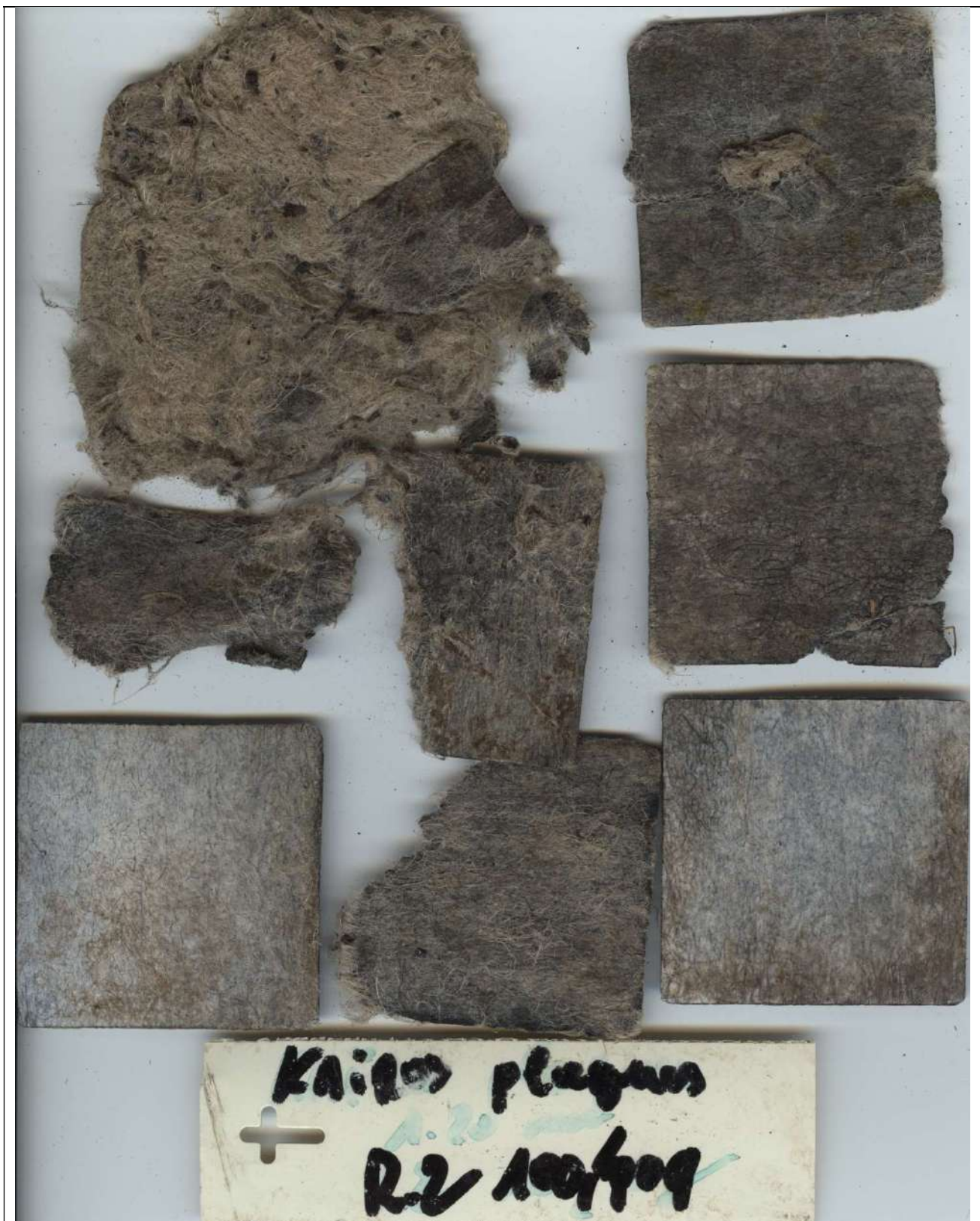
Répétition 2 – Obtention de résidus filamenteux et de quelques plaquettes peu désintégrées – 18.15 grammes pour 100.40 grammes initiaux
